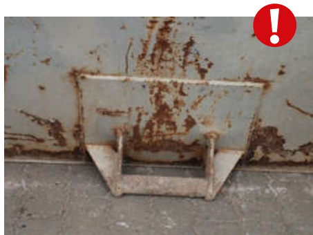
Abb. 17 Aufgeschweißtes Kip- plager entspricht nicht der DIN 30720-1
