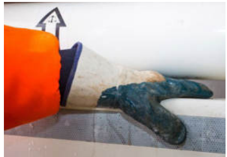
Abb. 24 Quetschstelle zwischen Zylinder und Rahmen
