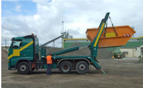
Abb. 32 Aufnehmen eines leeren Behälters
