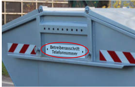
Abb. 26 Absetzbehälter mit Sicherheits- kennzeichnung
