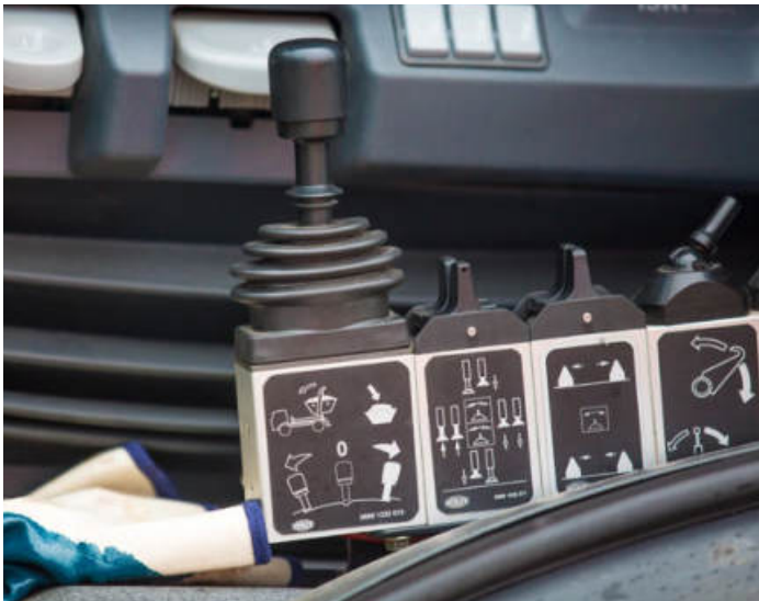
Abb. 4 Eindeutig gekennzeichnete Stellteile
