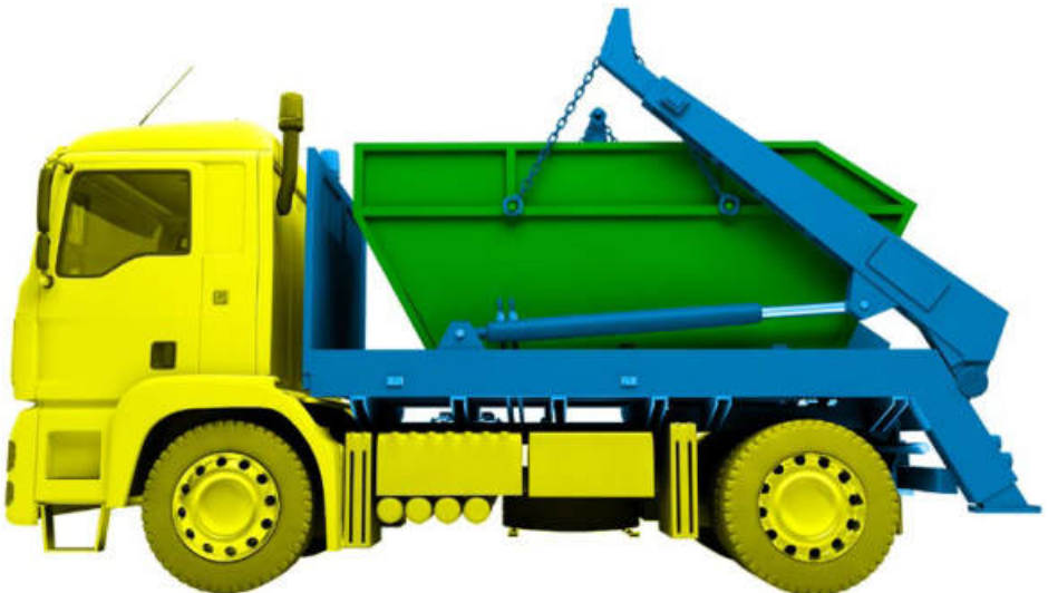
Abb. 2 Absetzkipperfahrzeug mit Absetzbehälter
