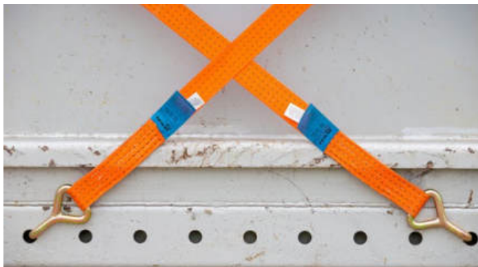
Abb. 19 Profil für die Stapelsicherung
