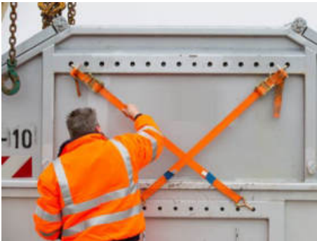
Abb. 35 Sicherung gestapelter Absetzbehälter durch X-Zurrung
