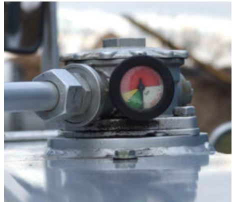
Abb. 8 Filter mit Verschmutzungsanzeige
