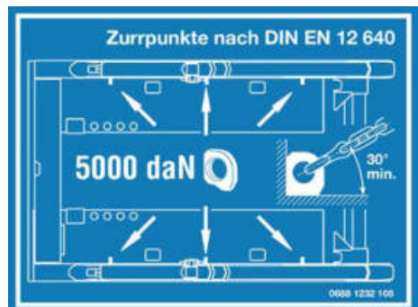
Abb. 28 Kennzeichnung der Zurrpunkte
