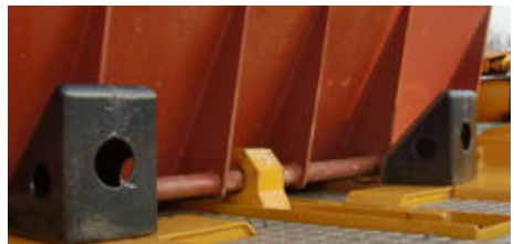
Abb. 14 Vordere Anschläge und Verriegelung
