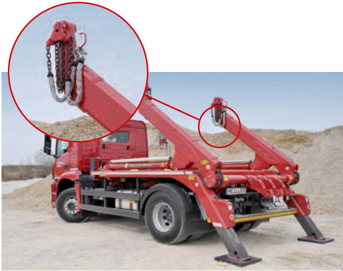
Abb. 37 Ketten in Transportstellung
